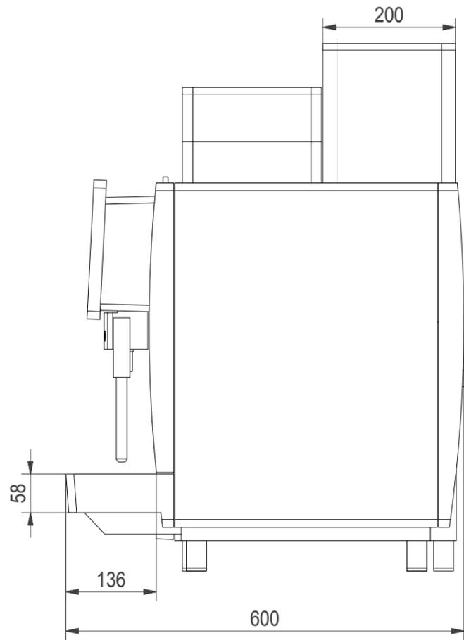
Mit dem optionalen Bohnenbehälter 2x 600g reduziert sich die Gerätehöhe von 796 mm auf 744 mm.
