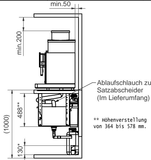
\* Mit dem im Lieferumfang des Satzabscheiders befindlichen Schlauch Di32xL1400 kann die Ablaufgarnitur direkt an den bauseitigen Siphon angeschlossen werden.
