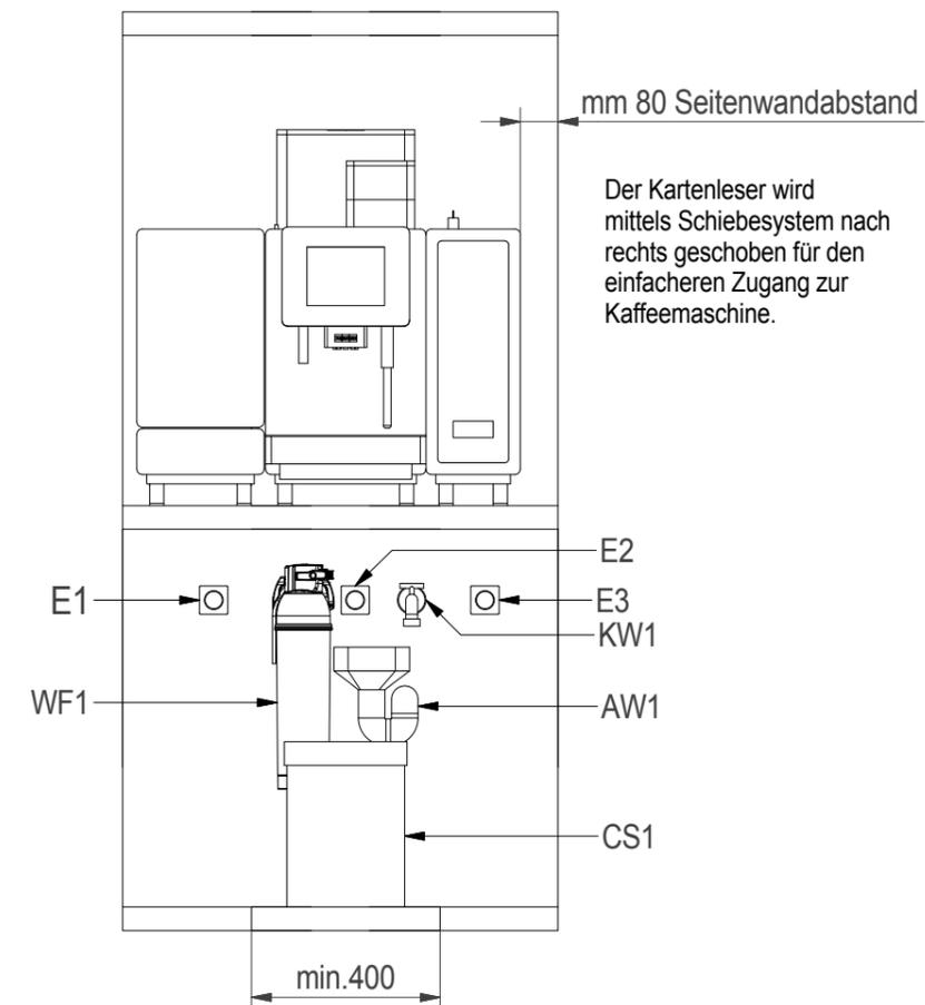
Der Kartenleser wird mittels Schiebesystem nach rechts geschoben für den einfacheren Zugang zur Kaffeemaschine.
