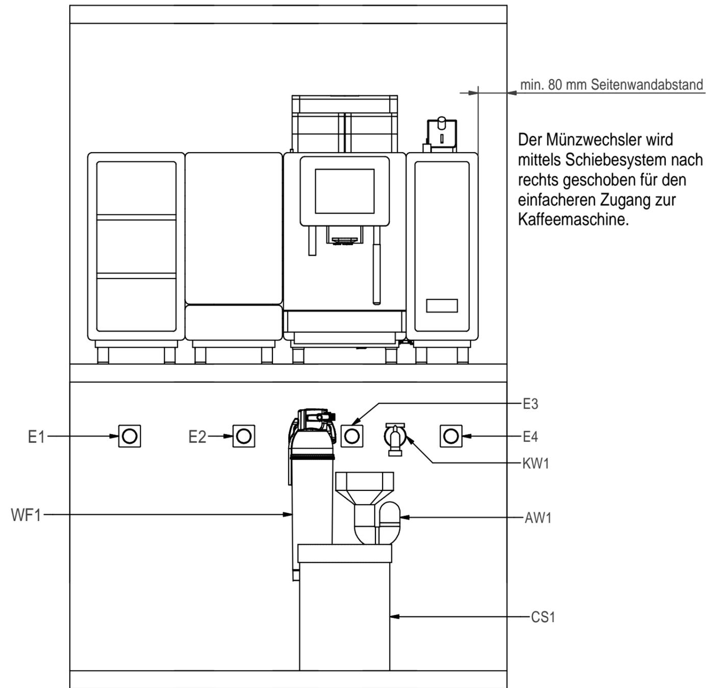
Der Münzwechsler wird mittels Schiebesystem nach rechts geschoben für den einfacheren Zugang zur Kaffeemaschine.
