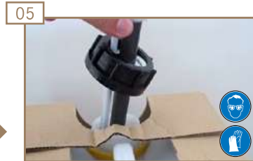
05 Ansaugschlauches mit Sonde in den neuen Kanister einführen und Aufsteckstück zuschrau-ben.
