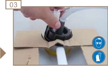
03 Aufsteckstück des Ansaug-schlauches mit Sonde auf-schrauben.
