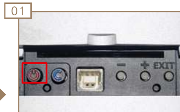
01 Maschine mit Ein/Aus Taste einschalten.
