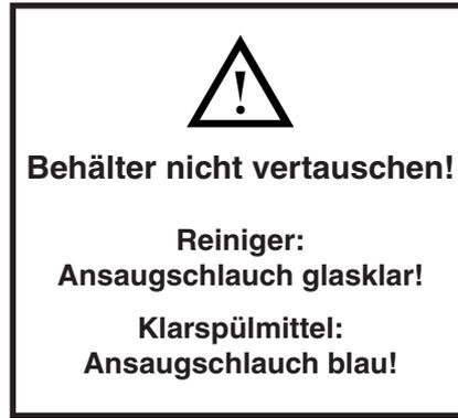
Füllstand von Reiniger- und Klarspülmittel-Behältern überprüfen. **Die Reiniger-Dosierpumpe ist vor zu langem Leerlauf zu schützen.** Bitte auf den Füllstand im Reinigerbehälter achten.
