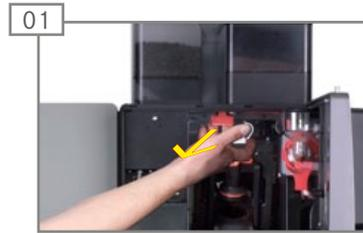
01 Verriegelungsschieber bis zum Anschlag nach vorn ziehen.
