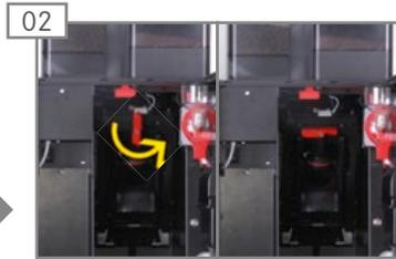
02 Brühmodulverriegelung im Gegenuhrzeigersinn lösen.
