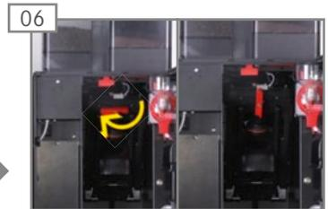
06 Brühmodul im Uhrzeigersinn verriegeln.
