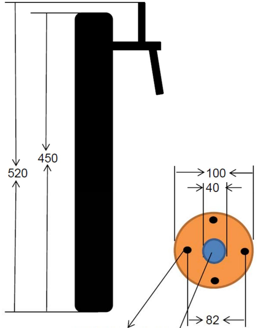
Ø Bohrung 10 mm
