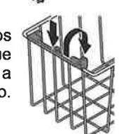
Os cestos podem ser colocados uns sobre os outros, colocando o cesto superior nas pegas que estão dobradas para dentro. Para tal, pressione a pega para baixo, levante-a e incline-a para dentro.
