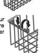
Les paniers peuvent être placés les uns sur les autres, en faisant reposer le panier supérieur sur les poignées repliées vers l'intérieur. Pour faire cela, veuillez appuyer sur la poignée, la soulever et la pousser vers l'intérieur.
